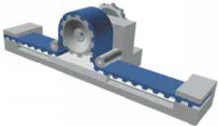
图4.2.2: 带有移动式电机的线性驱动器
