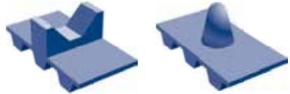
图6.4.10: 带有梯形槽的槽型夹板及圆锥形夹板
