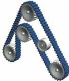
图3.2.2: 带有内侧平滑圆柱形轮的惰轮传动系统
